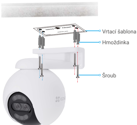
Obr. 1 Montáž na strop
